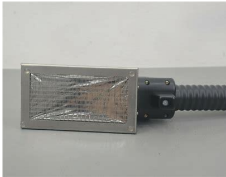
ZnS mince collée a un scintillateur plastique - \alpha/\beta\gamma
